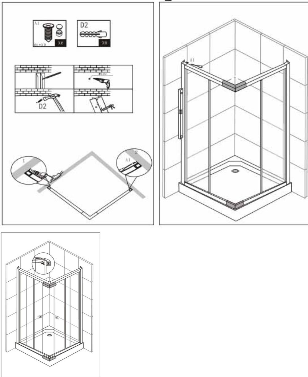
9. Bitte versichern Sie sich, dass vor der Installation der Boden nivelliert und in der Lage ist, das Gesamtgewicht der Dusche und deren Insassen zu tragen. Ein unregelmäßiger Boden oder unsachgemäße Winkel von Seitenwänden können zu ernsthaften Problemen für die Montage bedeuten.
