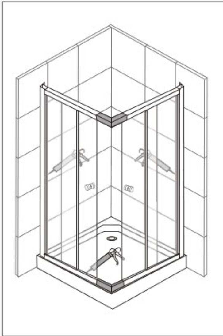
13. Spritzen Sie Silikon zwischen Wandprofil, Glas Profil und Unterschiene.
