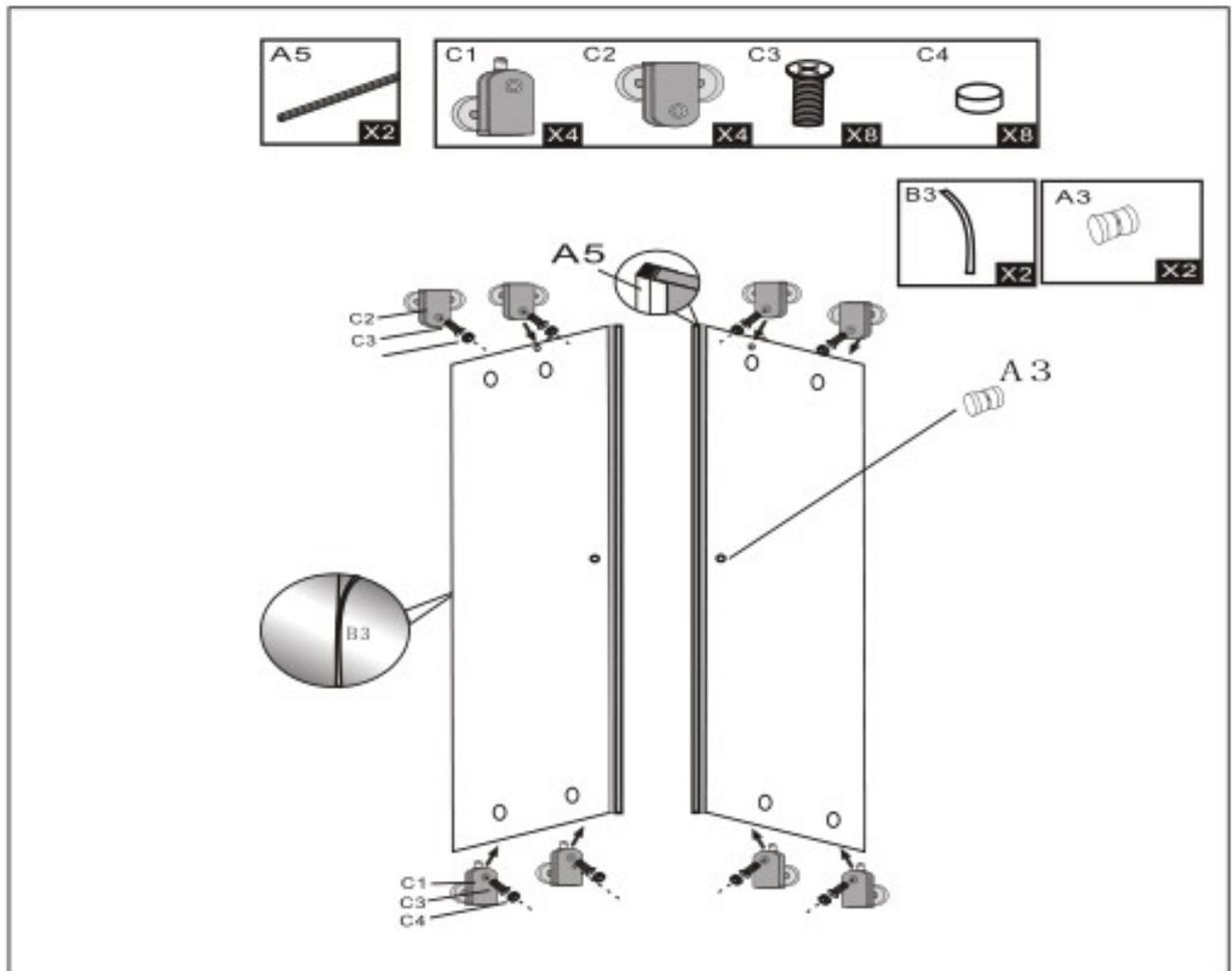
1. Montieren Sie die oberen und unteren Räder auf die Glastüren.
